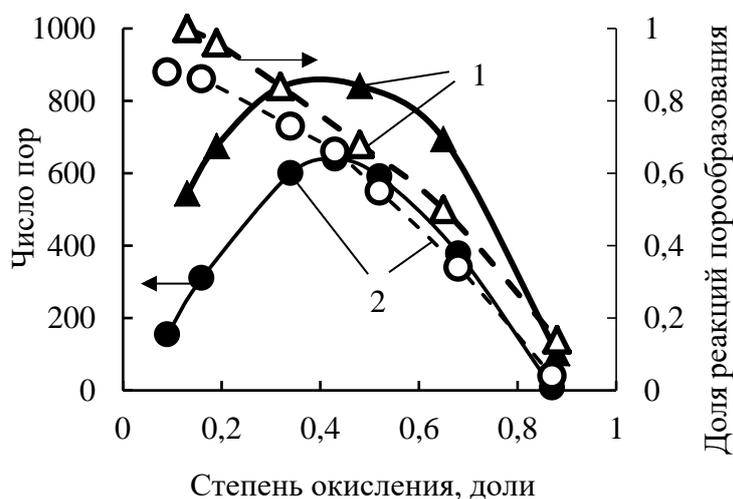
Рисунок 10. Влияние расхода  $\text{CO}_2$  на число образующихся пор и долю реакций порообразования при активации N234. Температура  $900$  °С. 1 – расход газа  $5$  мл/мин, 2 – расход газа –  $40$  мл/мин.
