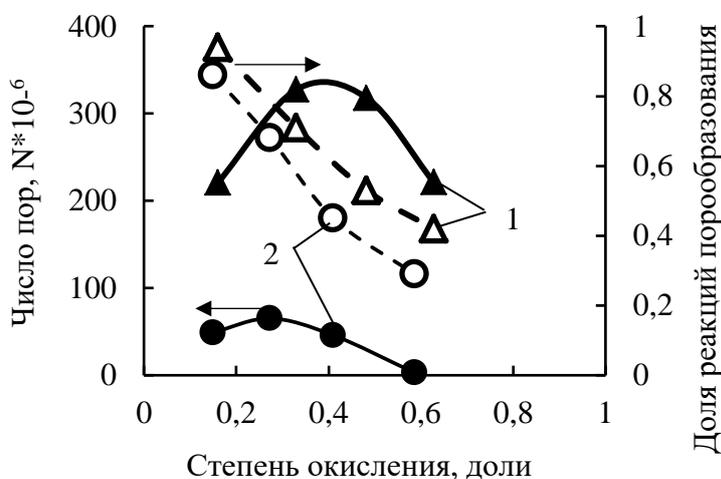
Рисунок 9. Влияние температуры на число образующихся пор и долю реакций порообразования при активации антрацита. Окисляющий агент  $\text{CO}_2$ ,  $\tau = 1,44$  с. 1 – температура  $850$  °С; 2 – температура  $1000$  °С.
